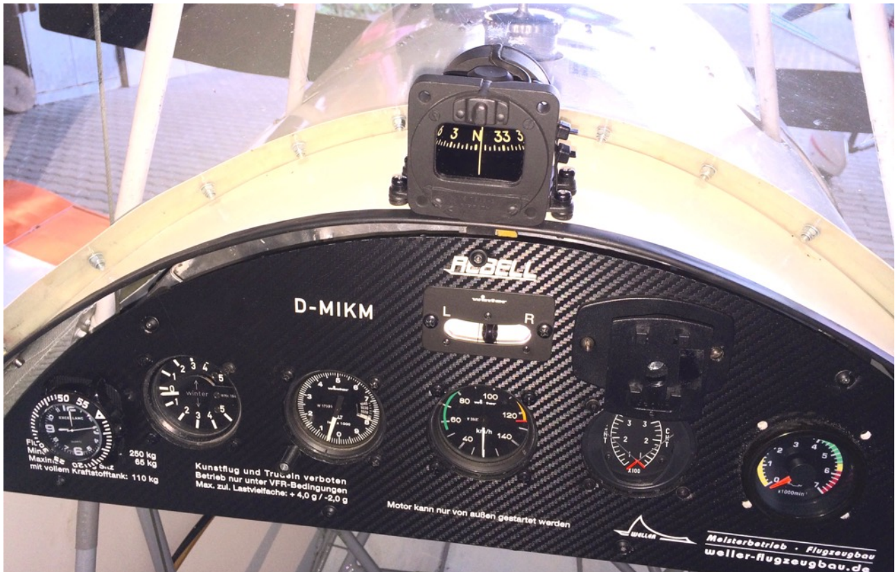
Bordinstrumente: Uhr mit drehbarer Lünette, Winter Variometer m/sec , Winter Höhenmesser bis 10.000 Fuß, Winter Fahrtmesser, Zylinderkopftemperatur recht und links, Drehzahlmesser, Libelle, Airpath-Kompass, Zubehör-Halterung
